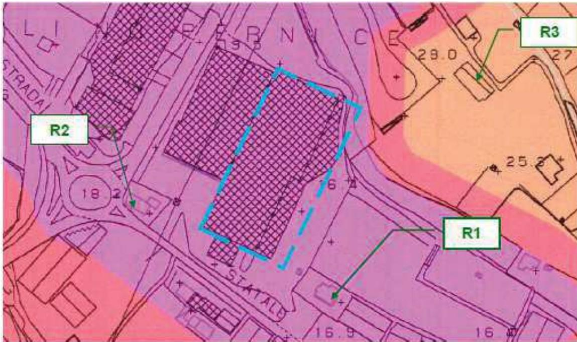
L'elaborato grafico seguente riporta l'ubicazione dello stabilimento e delle aree ad esso pertinenti. L'elaborato grafico contiene altresì l'indicazione delle posizioni ove sono stati condotti i rilievi fonometrici relativi al rumore residuo e la posizione dei principali punti di ricezione ossia le civili abitazioni presenti nella zona circostante il complesso IPPC.
